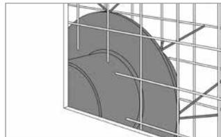
Bsp.: Befestigung in Stahlschalungen durch Schweißverbindungen (bauseits).
