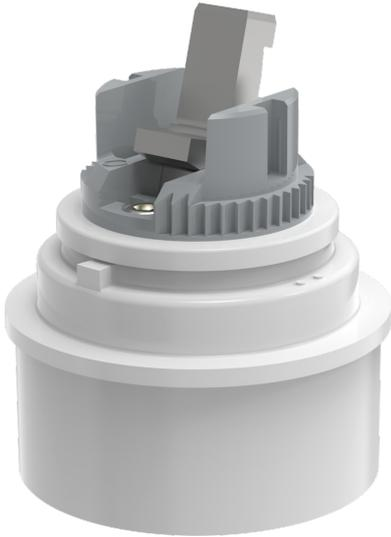
HANSAECO Steuerpatrone 4.8; Wasserbremse bei ca. 50% Wassermenge; Keramikscheiben mit integrierten Fettdepots; einstellbare Heißwassersperre (außer 0123, 0148, 0914, 0912); einstellbare Wassermengenbegrenzung bis ca. 6 l/min
