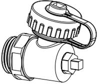
**Ersatz Füll-, Entleer-, Spül- und Entlüftungsvorrichtung 1/2"**
