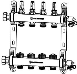
**Dynacon 150 Fußboden-Heizkreisverteiler**
