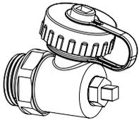
**Ersatz Füll-, Entleer-, Spül- und Entlüftungsvorrichtung 1/2"**
