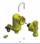
Sollte zu wenig Platz um das Rohr herum sein um den Abscheider einbauen zu können, kann der Fixierstecker entfernt und die drehbare Basis vom Abscheider getrennt werden. Nachdem die Basiseinheit im Rohr verschraubt ist, kann der Abscheider an die Basis angesetzt und mit dem Fixierstecker befestigt werden. Dieser Vorgang muss sehr sorgfältig ausgeführt werden um sicher zu sein, dass die beiden Teile wieder richtig zusammengesetzt werden ohne die Dichtfläche und die Abdichtung zu beschädigen.
