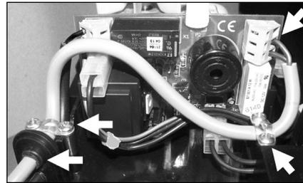
将警报器连接电缆沿平行于电源线的方向插入冷凝泵。为此，电缆套管的第二个开口必须保持开启。
