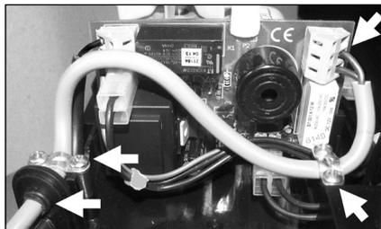
A riasztási csatlakozóvezetékét a hálózati vezetékkel párhuzamosan kell elvezetni a kondenzátszivattyú foglalatában. Ehhez az átvezetési tokon lévő második nyílást is meg kell nyitni.
