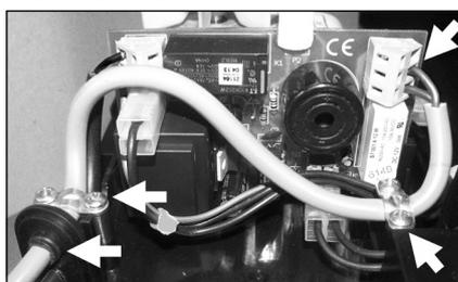
Alarmowy przewód przyłączeniowy wprowadzony jest do obudowy pompy kondensatu równolegle do przewodu sieciowego. W tym celu należy otworzyć drugi otwór w przepuszczeniu kablowym.
