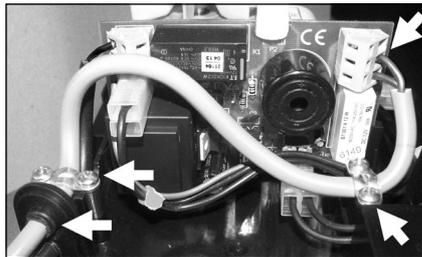
Die Alarm-Anschlussleitung wird parallel zur Netzleitung in das Gehäuse der Kondensatpumpe geführt. Hierzu muss die zweite Öffnung in der Durchführungsstülpe geöffnet werden.
