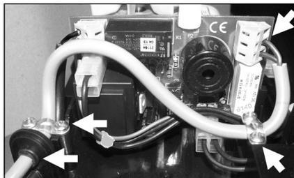
De alarmaansluitkabel wordt parallel aan de stroomkabel in de behuizing van de condensaat-afvoerpomp geleid. Hiertoe moet de tweede opening in de doorvoerhuls worden geopend.
