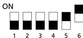
DIP-Schalter Werkseinstellung KaControl-Gerät
