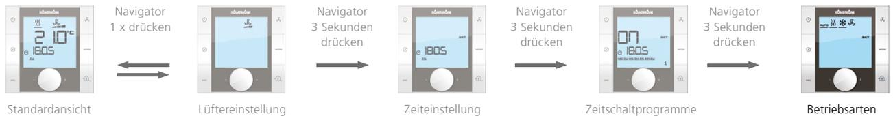
Die Betriebsart kann je nach Parametereinstellung mittels des Navigators eingestellt werden.
