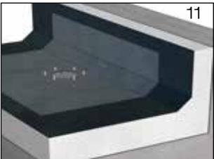
2.6 **Anschlussbahn** bauseits aus vorhandener Bitumen-Dachdichtungsbahn, Größe: 700 mm x 1000 mm, zuschneiden (Bild 11). Mit Locheisen Löcher  $\varnothing = 14$  mm für die Durchführung der Gewindebolzen in der Anschlussbahn vorsehen. Der Losflansch kann als Schablone benutzt werden. Anschlussbahn im Schweißverfahren mit bereits verlegter erster Lage der Dachdichtungsbahn verbinden.
