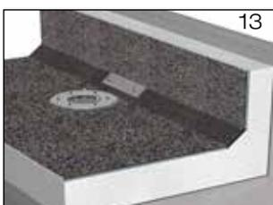
2.9 Dachdichtungsbahn mit Losflansch und beiliegenden Sechskantflanschmuttern verkleben (Bild 13). Beiliegende Sechskantflanschmutter mit Steck- oder Ringschlüssel SW 15, beginnend auf der Flanschseite unter  $45^\circ$ , anziehen. Danach die restlichen Sechskantflanschmutter gegenüberliegend anziehen. Anzieh-Drehmoment: 20 Nm. Überstände der Abdichtungslage in den Einlaufbereich sind zu entfernen.
