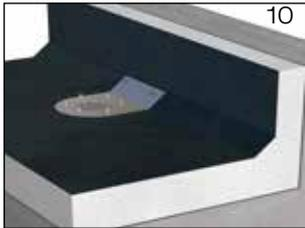
2.5 Erste Lage der **Dachdichtungsbahn** über Attikaablauf ausrollen und im Bereich des Festflansches aussparen (Bild 10).
