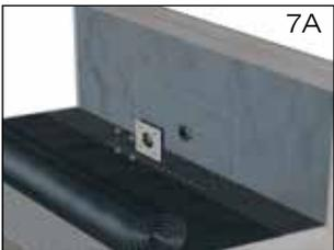
1.9 Bei Ausführung DN 50 Kompressionsdichtung über Dampfsperrbahn anbringen und mit Losflansch und beiliegenden Schrauben verklemmen (Bild 7A). Beiliegende Schrauben mit Steck- oder Ringschlüssel SW 17 gegenüberliegend anziehen. Anzieh-Drehmoment: 20 Nm (Dampfsperrbahn aus Bitumen) bzw. 30 Nm (Dampfsperrbahn aus Kunststoff). Dichtelement in Muffe des Schiebeflansches einlegen.
