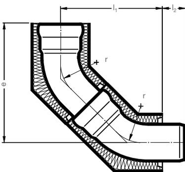
**Montagmaße bei Verwendung von 2 Bogen mit gleichem Winkel  $\alpha = 45^\circ$**
