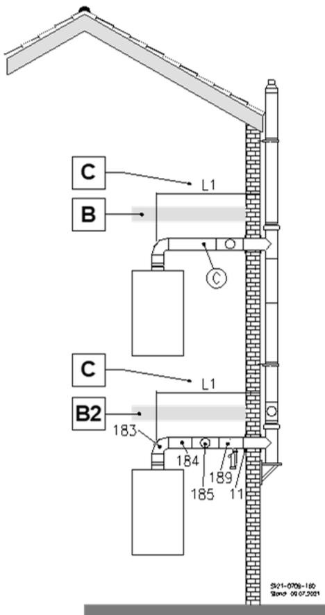
Abb. 45: C<sub>(12)3x</sub> Mehrfachbelegung an der Außenwand
