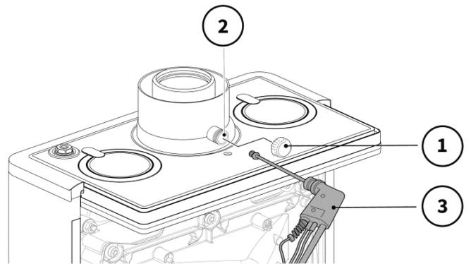
Abb. 93: Mess-Stelle ② am Abgasanschluss
