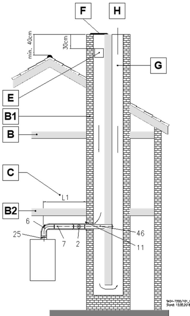
Abb. 33: C<sub>43x</sub> Anschluss an ein Luft-Abgas-System (LAS)
