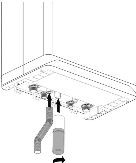
Abb. 8: Montage der Siphontasse und des Kondensatschlauchs
