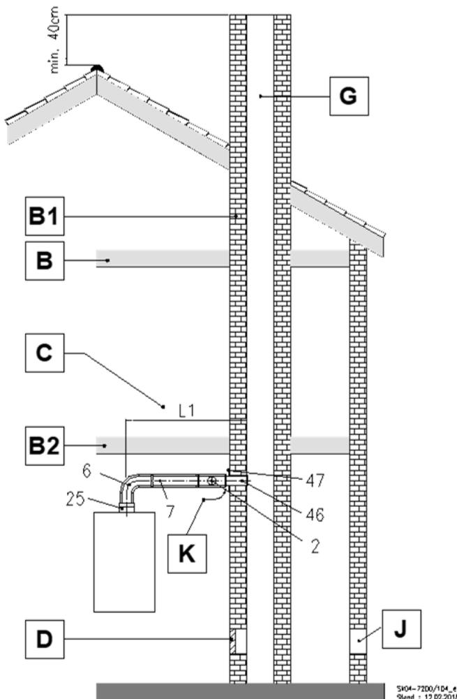
Abb. 29: B<sub>33</sub> Abgasrohr endet im feuchteunempfindlichen Schornstein
