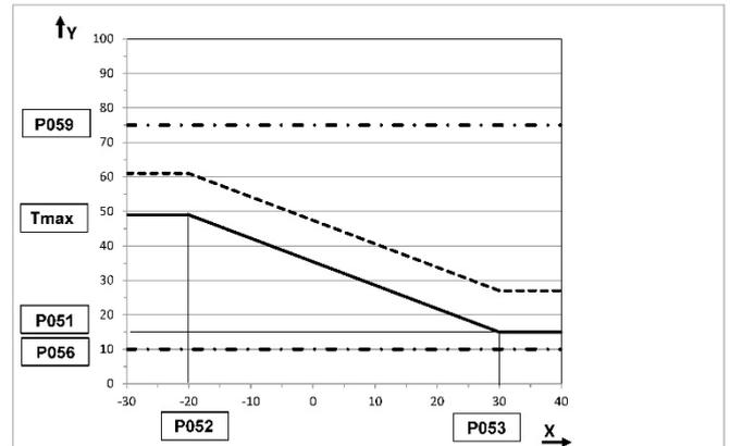
Abb. 89: Heizkennlinie mit Parallelverschiebung (T<sub>RaumSoll</sub> = 24°C, P054 = 3)
