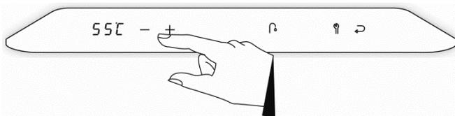
Abb. 77: Änderung des Sollwerts für Trinkwarmwassertemperatur
