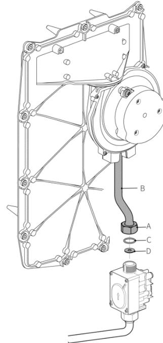
Abb. 91: Umbau Gasdüse
