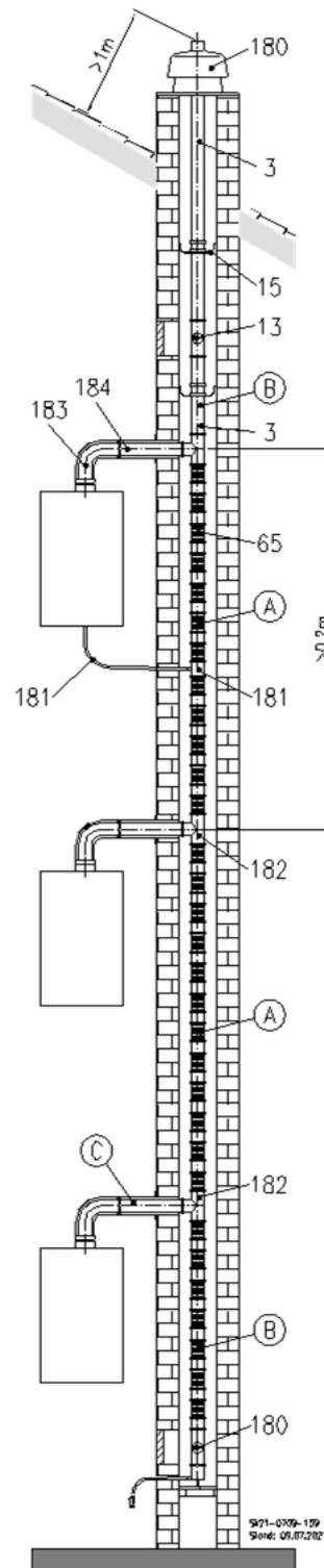
Abb. 42: C<sub>(11)3x</sub> Mehrfachbelegung im Schacht
