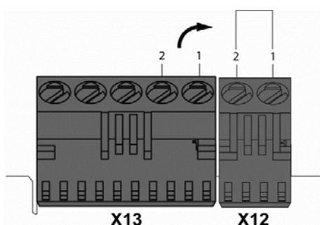
Abb. 17: Versetzte Brücke für Betrieb mit LANfunk-Box
