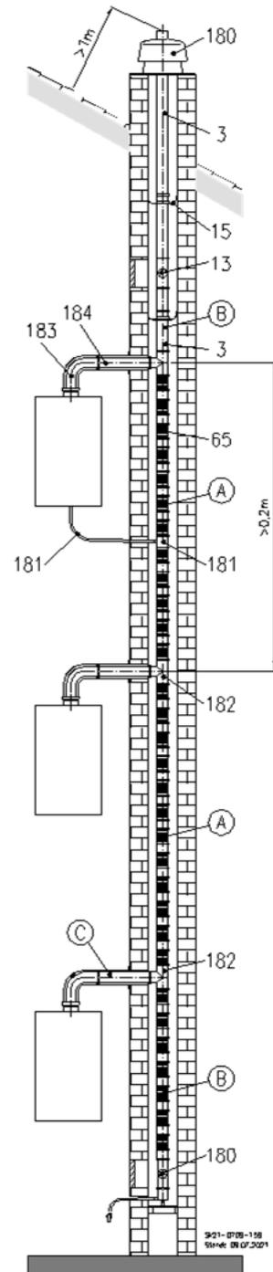
Abb. 50: C<sub>(14)3x</sub> Mehrfachbelegung im Schacht
