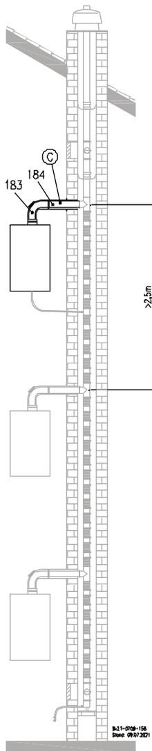
Abb. 40: C<sub>(10)3x</sub>Mehrfachbelegung im Schacht
