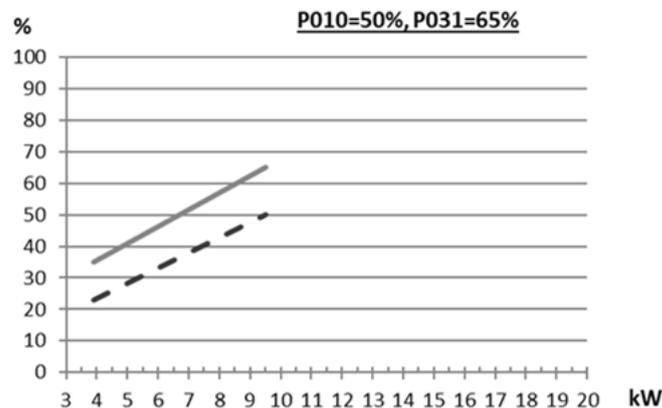
Abb. 84: Heizleistung und Pumpendrehzahl am Beispiel ecoGAS Pro 18 mit reduziertem Parameter P010 (= 50%) und unverändertem Parameter P031 (= 65%)
