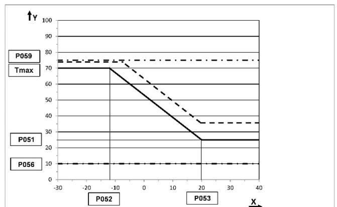
Abb. 90: Heizkennlinie mit Parallelverschiebung (T<sub>RaumSoll</sub> = 24°C, P054 = 3) und Begrenzung durch Parameter P059
