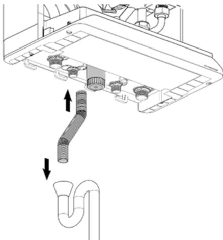
Abb. 104: Montage Kondensatschlauch
