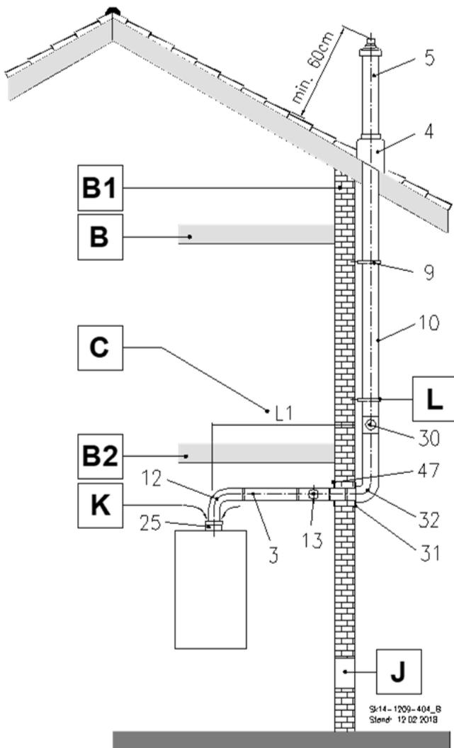
Abb. 27: B<sub>23</sub> Abgasrohr an der Außenwand
