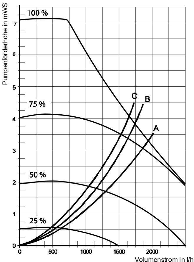
Abb. 86: Hydraulischer Druckverlust des Wärmetauschers auf der Heizungsseite
