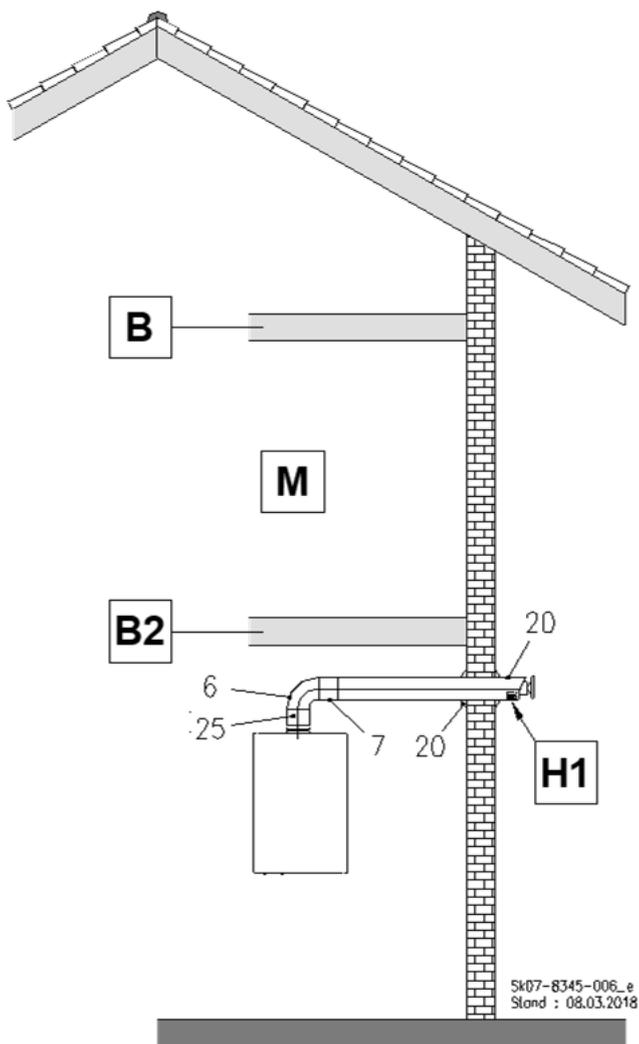
Abb. 30: C<sub>13x</sub> Luft-Abgas-Rohrsystem horizontal durch die Außenwand
