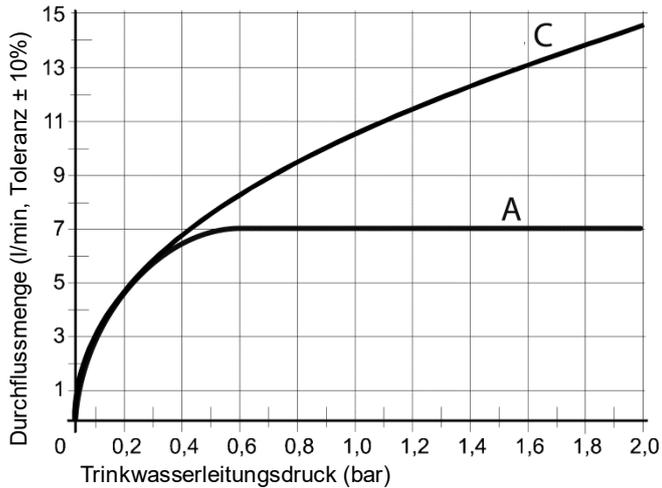
Abb. 13: Widerstandsdiagramm Trinkwasser-Tauscherschlange
