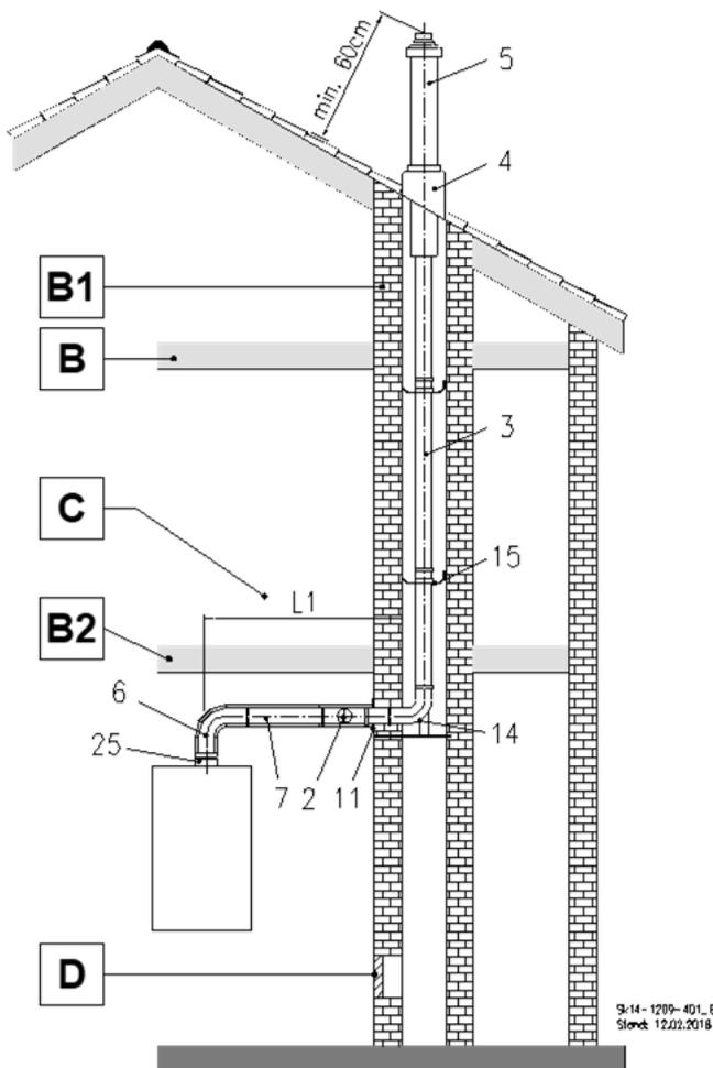
Abb. 37: C<sub>93x</sub> Luft-Abgas-System im Schacht und Luft-Abgas-Rohrsystem mit Dachdurchführung
