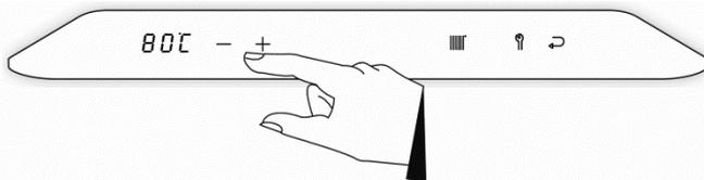
Abb. 79: Änderung der max. Vorlauftemperatur für den Heizbetrieb
