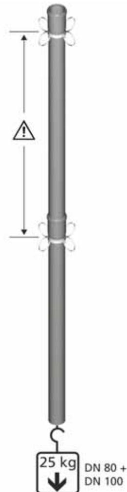
Abb. 56: Abgasrohre mit Stoppring-Technik ①
