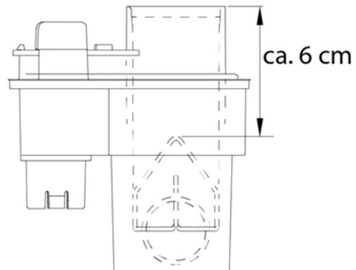
Abb. 100: Korrekte Position von Sicherungsklammer und Kunststoffkugel
