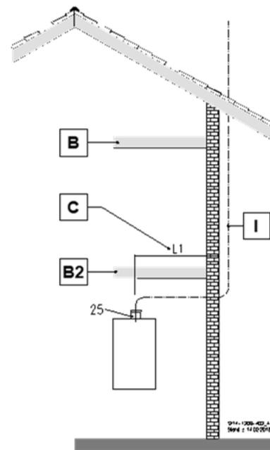
Abb. 35: C<sub>63x</sub> Für Anschluss an eine nicht mit der Gasfeuerstätte geprüfte Verbrennungsluftzuführung und Abgasabführung
