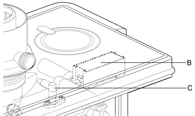
Abb. 105: Zündeinheit B mit Zündelektrode C
