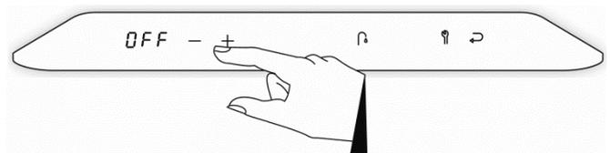
Abb. 78: Änderung der Trinkwarmwasser-Komfortfunktion
