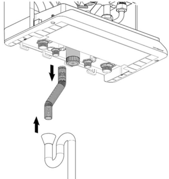
Abb. 96: Demontage des Kondensatschlauchs
