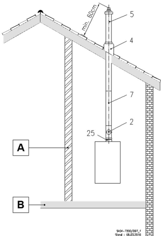
Abb. 32: C<sub>33x</sub> Dachheizzentrale mit der Durchführung senkrecht durch ein Schrägdach
