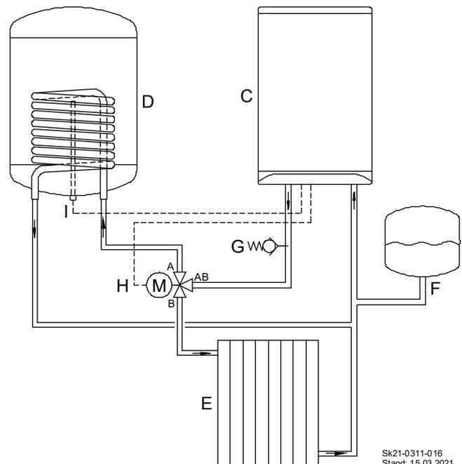
Abb. 22: Trinkwarmwasserbereitung mit externem Speicher über 3-Wege-Umschaltventil
