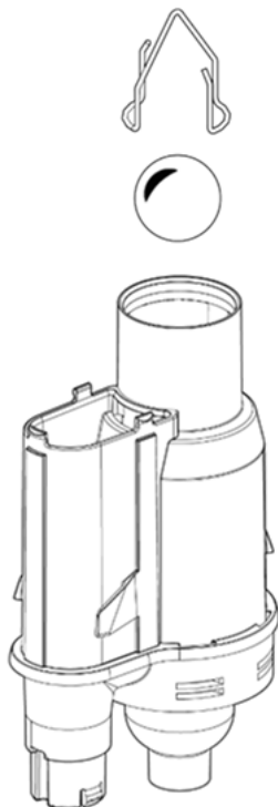
Abb. 99: Sicherungsklammer und Kunststoffkugel des Siphons
