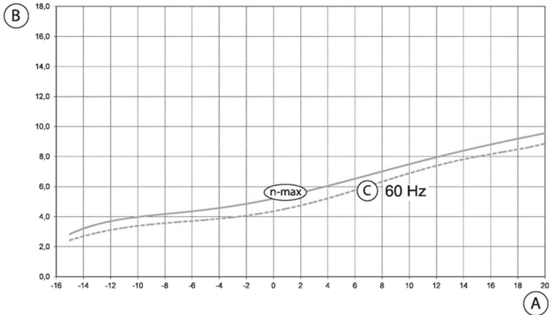
Abb. 50: Heizleistung ecoWP 7Xe bei Vorlauftemperatur 35°C
