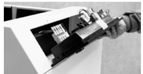
Abb./Fig. 12: Ausklappen des Unit-Schaltfeldes Ouverture du tableau de commande de l'unité
