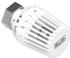
Mit dem Thermischen-Fluid-Regler (TFR) kann eine Warmwassertemperatur zwischen 20 und 60 °C schnell und exakt geregelt werden. Unmittelbar im Warmwasseraustritt des Wärmetauschers befindet sich ein Temperatur-Wendelfühler, der über ein Kapillarrohr mit dem Regler verbunden ist.
