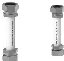
Die Distanzstücke sind aus nahtlos geschweißtem Edelstahlrohr mit Anschlussgewinde. Die Einbaulänge für den Kaltwasserzähler ist 130 mm mit einer Anschlussgröße G 1" AG. Die Einbaulänge für den Wärmemengenzähler ist 110 mm mit einer Anschlussgröße G 3/4". Beide Passstücke sind für den Normalbetrieb ohne Einschränkungen zugelassen.
