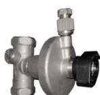
Der Differenzdruckregler Heizkreis ist zur Durchführung eines hydraulischen Abgleichs und somit zur Versorgung eines unregulierten Heizkreises durch die Roth FlatConnect Wohnungsstation. Der Regler befindet sich im Rücklauf der unregulierten Heizkreises zur Versorgung einer Radiatorheizungsanlage und ist über ein Kapillarrohr mit dem Vorlauf verbunden. Der einstellbare Differenzdruck befindet sich in einem Arbeitsbereich von 5 bis 25 kPa. Die Voreinstellung ist werkseitig auf 15 kPa eingestellt.
