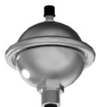
Der Wasserschlagdämpfer schützt die Trinkwasserinstallation vor Beschädigung und reduziert mögliche Körperschallemissionen durch Druckschläge, die durch ein schnelles Schließen von Entnahmearmaturen entstehen können. Der Wasserschlagdämpfer kann Druckspitzen bis 20 bar bei einem Fassungsvermögen von 162 ml aufnehmen.
