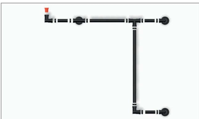
5. Vormontierte Entlüftungsleitung auf den zweiten Stützen setzen und Doppellippendichtung einfetten.
