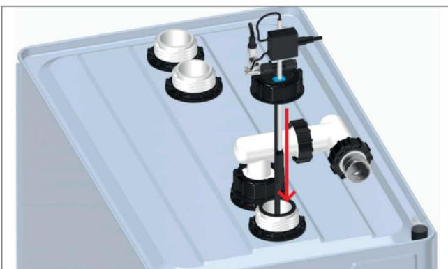
4. Vormontierte Entnahme-Sammelarmatur mit Grenzwertgeber und Grundbausatz F-Stop sowie Entnahme-Schnellschlussventil auf ersten Tankstutzen montieren.
