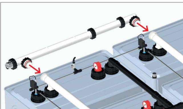
4. Vormontierte Füllleitung mit Füllanschluss LORO-X DN50 an den Öffnungen der T-Füllrohren der Tankanlage anbringen.
