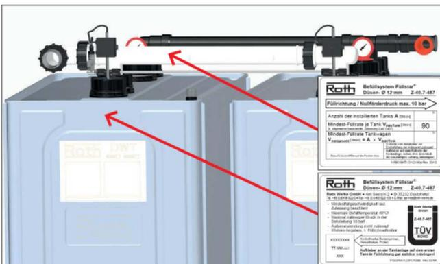
10. Zulassungsaufkleber ausfüllen, an Füllleitung und Tank anbringen. Anschließen der Überfüllsicherung, siehe Kapitel: "Anschließen des Überfüll-Sicherheitsystems F-Stop GWG-FSS". Zu beachten ist die Montage- und Bedienungsanleitung F-Stop GWG-FSS.
