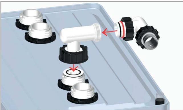
2. Füllanschluss mit Winkel-Verteilerrohr (mit Sieb) und Winkel-Füllrohr auf dem zweiten Tankstutzen (mit Tauchrohr) montieren.
