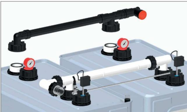
8. Entlüftungsleitung auf die vierte Stützenreihe montieren, Winkel-Sammelrohr-Entlüftung und Anschlagdichtung für LORO-X DN40 einsetzen.
