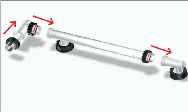
3. Füllleitung mit Füllanschluss LORO-X DN50 vormontieren, O-Ringe einfetten, Schutzschläuche von den Düsen entfernen.
