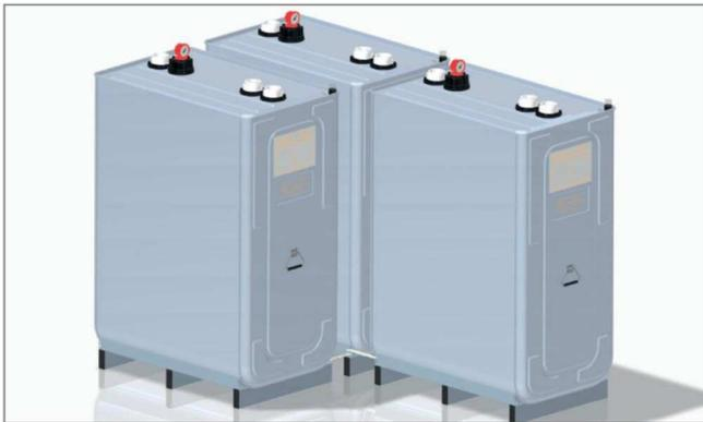
1. Tanks auf Fußgestelle aufsetzen, Füllstandanzeiger in die Buchsen des dritten Tankstutzens einschrauben.
