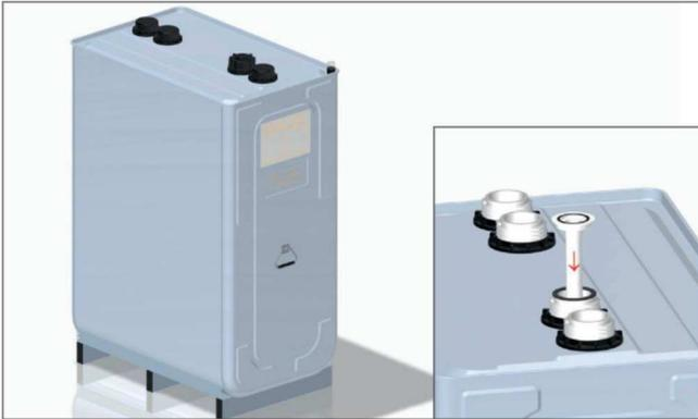
1. Tank auf Fußgestell aufsetzen, Dokumente aus dem Tankstutzen entnehmen, das Tauchrohr in den zweiten Stutzen setzen.
