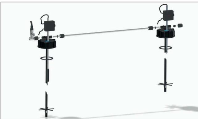
5. Bei einreihiger Tankaufstellung Entnahmeleitung mit Grenzwertgeber und Füllstandsensoren vormontieren. Montieren des Entnahme-Schnellschlussventils an Entnahme-Sammelarmatur.
