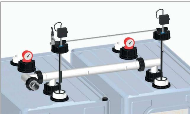
6. Vormontierte Entnahmeleitung auf die erste Stützenreihe aufsetzen, dabei Entnahme-Sammelarmatur mit Grenzwertgeber auf dem ersten Tank in Füllrichtung montieren.
