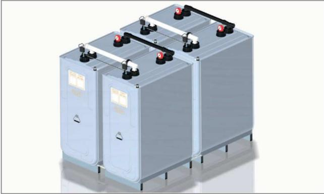
1. Den vierten Tank auf das Fußgestell setzen, montieren der Füllstandanzeiger, anbringen der T-Füllrohre Füllstar® von Tank zu Tank, vorher das Tauchrohr in den Stutzen stecken, montieren und anbringen der Entnahmeleitung an die Entnahme-Sammelarmatur mit GWG, vormontierte Entlüftungsleitung auf die Tankstutzen setzen.
