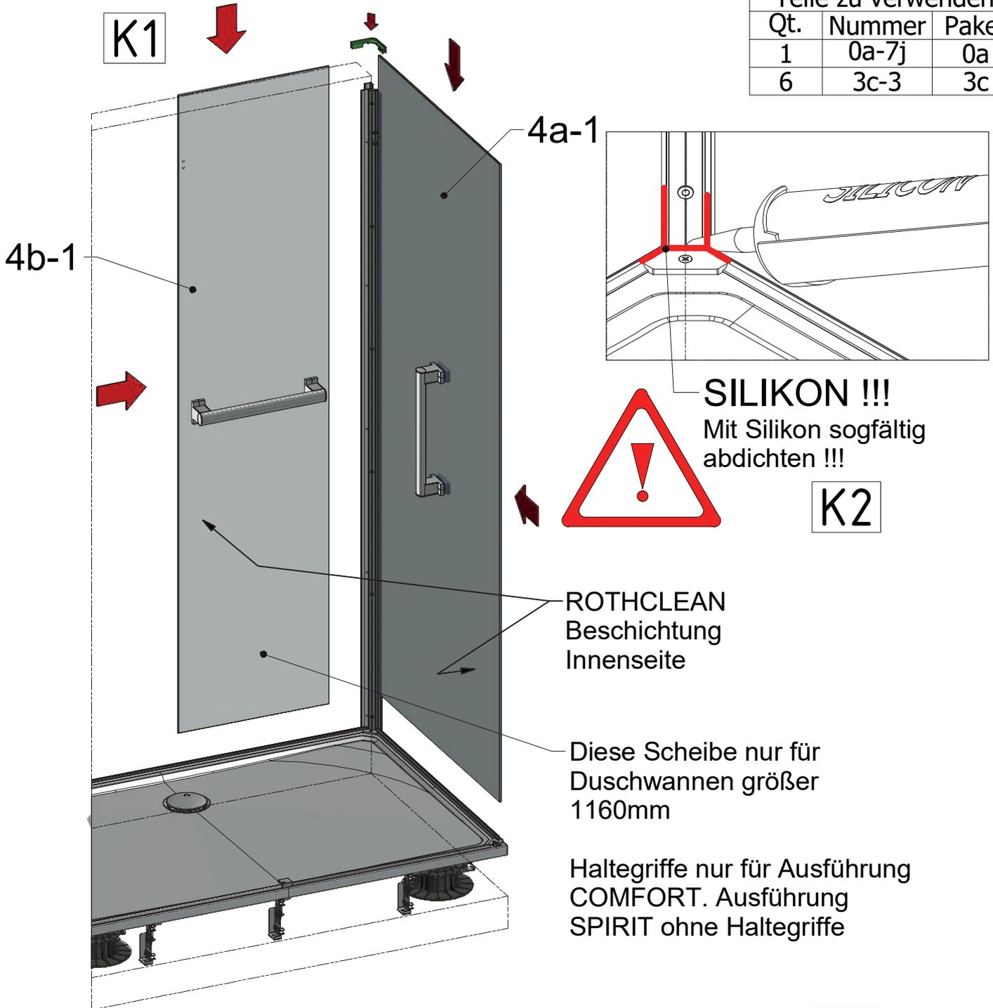
Montagehilfe 0a-7j benutzen um Scheiben ausrichten und vorläufig zu fixieren.
