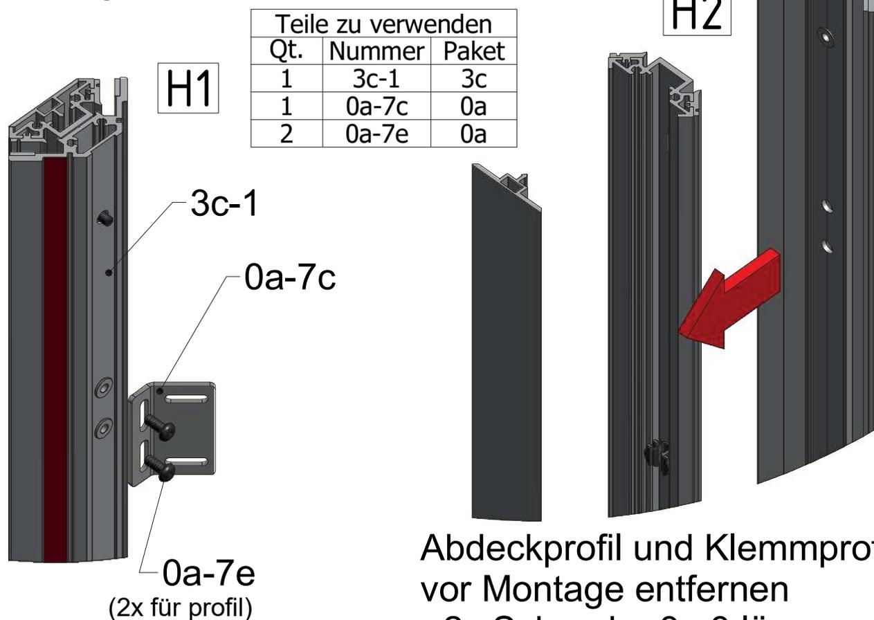
Abdeckprofil und Klemmprofil vor Montage entfernen
