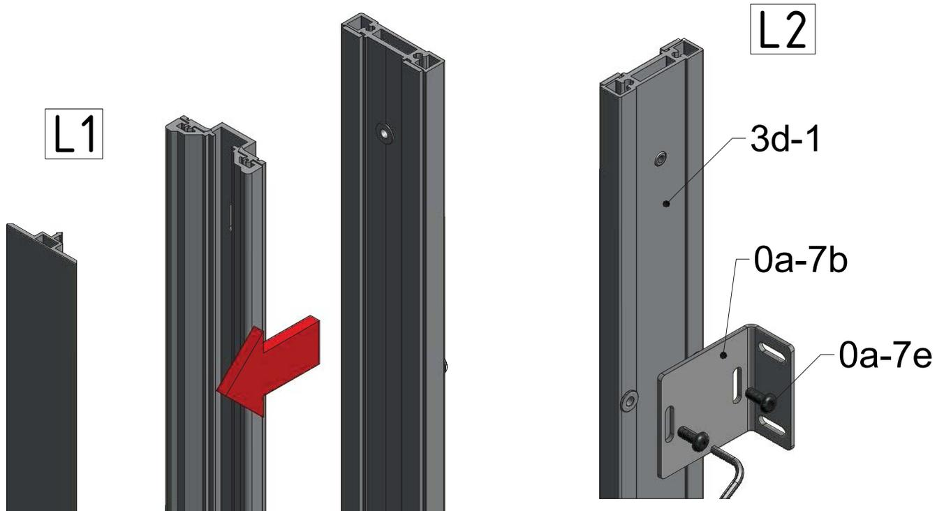
Abdeckprofil und Klemmprofil vor Montage entfernen - 2x Schraube 3d-3 lösen
