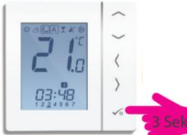
Halten Sie den Hacken für 3 Sekunden gedrückt. Wenn Pro9 aufleuchtet können Sie mit dem Pfeil nach Rechts weitere Menüparameter durchgehen. Die Reihenfolge ist : Prog; Uhrzeit/ Datum; Offset und dann Heizen/ Kühlen.
