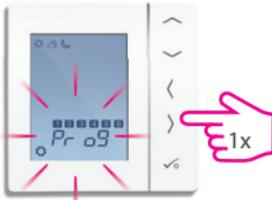
Im Offset können sie von -3C bis +3C die angezeigte Temperatur im Regler anpassen.
