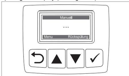
Bei einem weiteren Druck auf die -Taste haben Sie die Möglichkeit, mit der -Taste eine manuelle Rückspülung auszulösen.
