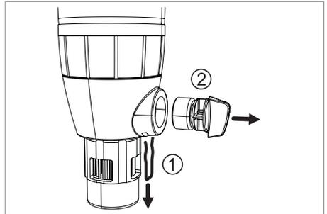
Setzen Sie die Rückspülautomatik mit der Hauptachse senkrecht an die Position des demontierten Rückspülgriffes.
