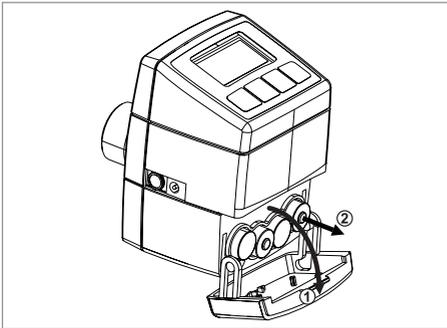
Klappen Sie die Abdeckung auf (1) und legen Sie die Batterien ein bzw. tauschen Sie die Batterien aus (2).
