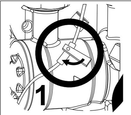
Schließen Sie das Nadelventil wieder. Beobachten Sie den Ablauftrichter. Der Differenzdruck über 140 mbar liegen und der Eingangsrückflussverhinderer (RV1) muss wieder völlig schließen, ansonsten liegt eine Verschmutzung oder ein mechanischer Defekt vor.
