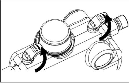
Entlüften Sie die Armatur über die beiden Nadelventile. Schließen Sie die beiden Nadelventile anschließend wieder.
