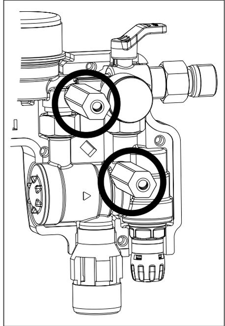
Montieren Sie die Nadelventile des Messgerätes an den Wartungskugelhähnen 1 + 2.
