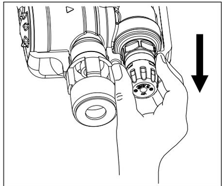
Zur Senkung des Fülldrucks den Einstellgriff in Richtung Minus (-) und zur Erhöhung in Richtung Plus (+) drehen - Der eingestellte Druck wird auf dem Manometer angezeigt.
