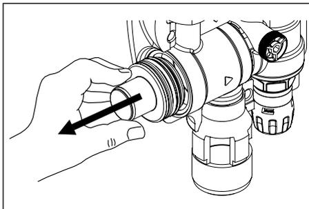
Reinigen Sie die Patrone mit kaltem, klarem Wasser bzw. tauschen Sie die Patrone aus.
