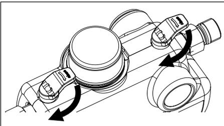
Entfernen Sie die Manometerstopfen 1 + 2, um die Armatur drucklos zu machen und montieren Sie Wartungskugelhähne.
