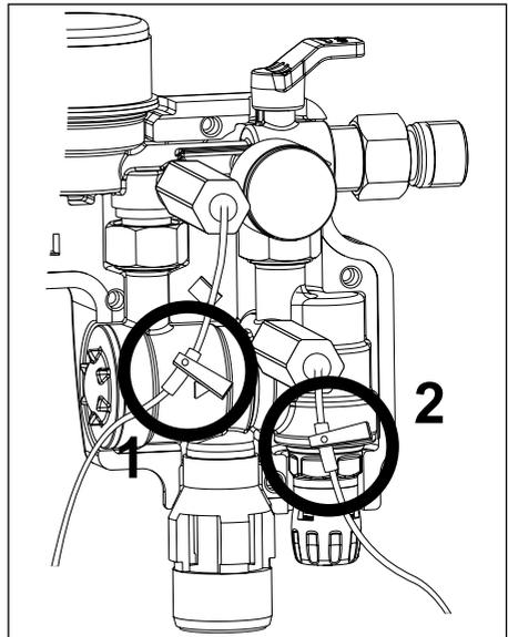
Montieren Sie das Messgerät und öffnen Sie die beiden Absperrungen.
