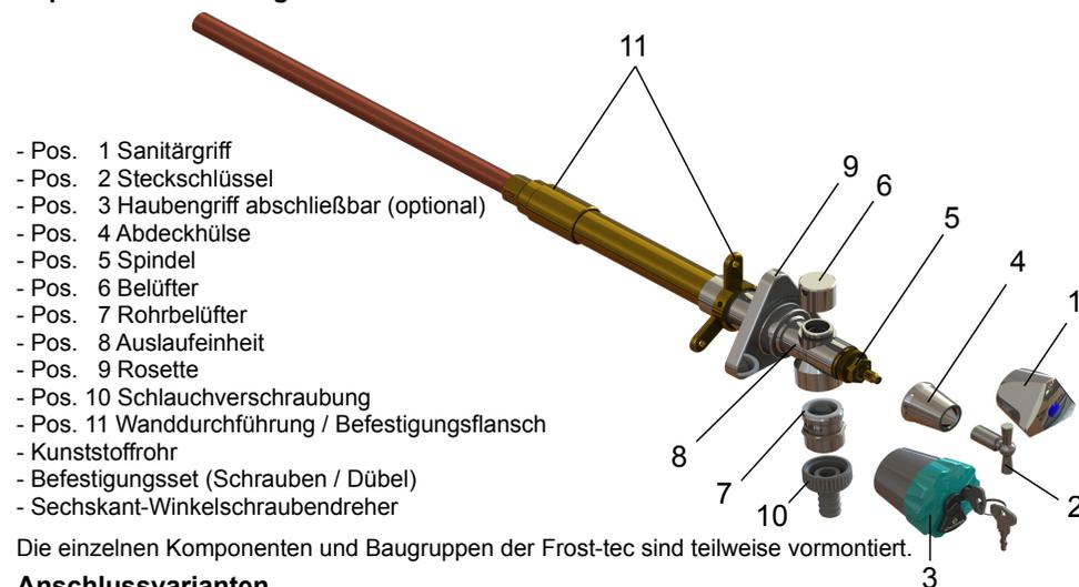
Die einzelnen Komponenten und Baugruppen der Frost-tec sind teilweise vormontiert.
