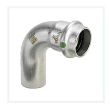
Sanpress Inox-Bogen 90° mit SC-Contur - Einsteckende, Pressanschluss Ausstattung Dichtelement EPDM
